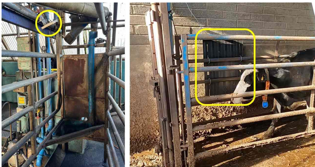
Ffigur 2.4. Un o'r antenau UHF yn un o'r wyth stâl odro (chwith, wedi'i chylchu mewn melyn), a'r darllenydd panel LF sefydlog (ar y dde, yn y blwch melyn) ar y rhedfa ymadael gul.
