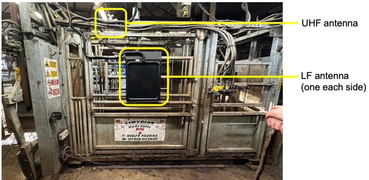
Ffigur 2.1 Darllenwyr UHF (top) ac LF (canol) sefydlog fel y'u gosodwyd yn y craets pwyso ar fferm bîff 1 Lloegr.
