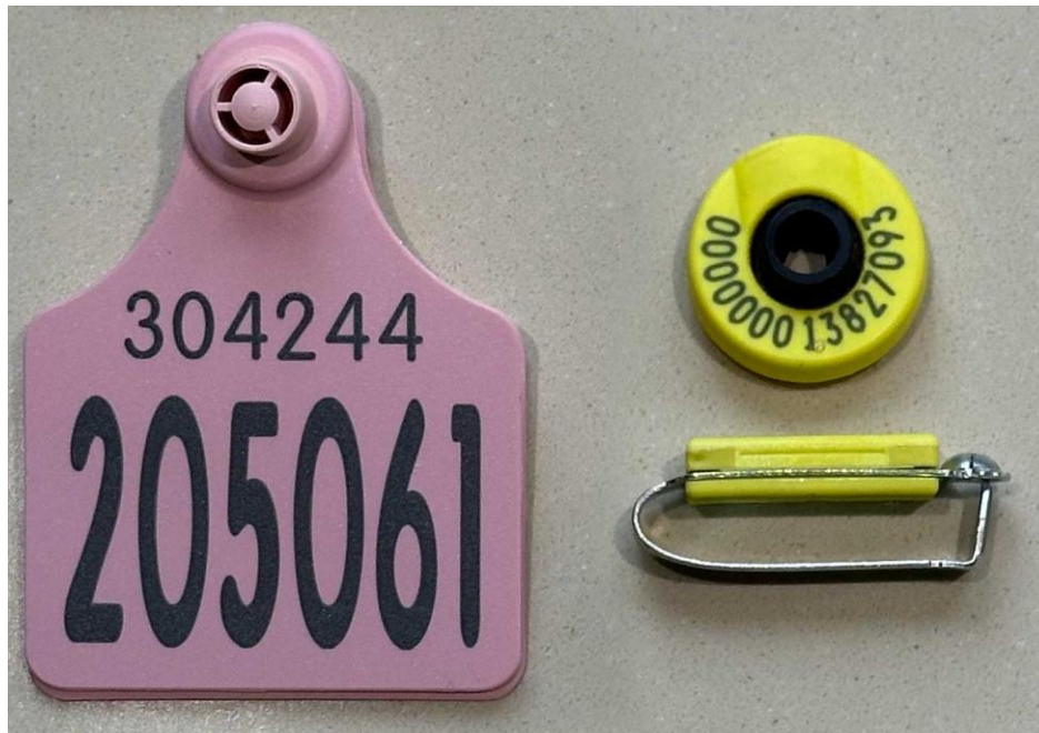
Ffigur 6.2. Maint tag fflag UHF (chwith) o'i gymharu â thag botwm LF (dde uchaf) a thag metel LF (dde isaf). Mae tag fflag UHF yn 60mm o led (graddfa o tua 1:1 ar A4).
