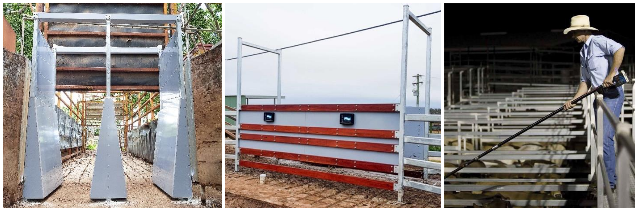
Ffigur 5.2. Llundiau o rai enghreifftiau o offer darllen LF 'Diwydiannol' gan Allflex yn Awstralia. Ar y chwith mae System Amlddarllen LF ar gyfer gwartheg mewn llwybrau cul (sy'n amrywio o'r fersiwn dau fae a ddangosir yma hyd at chwe bae). Yn y canol mae Darllenydd Llif Uchel LF ar gyfer darllen gwartheg yn gyflym. Ar y dde mae darllenydd ffon LF hir iawn (ar gael hyd at 3m o hyd) ar gyfer
