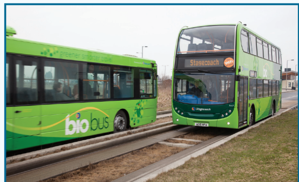
BCT - Bws Cyflym Tramwy. Amryw o dechnolegau gan gynnwys gwahanu llawn neu rannol o rwydwaith bysiau ansawdd uchel i ffwrdd o ddefnyddwyr ffyrdd eraill. Gweithrediad a pherfformiad mwy tebyg i reilffyrdd/tram ysgafn yn hytrach na gwasanaethau bysiau lleol gyda llai o stopiau neu siwrnai fyrrach. Yn y DU yr enghraifft gorau yw'r ffyrdd bws tywysedig yng Nghaergrawnt.
