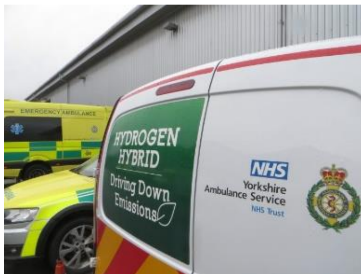
Ffigur 14: Cerbydau Yorkshire Ambulance a droswyd i danwydd dwbl hydrogen-diesel gan ULEMCo (33)
